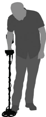
Высота штанги отрегулирована неверно
